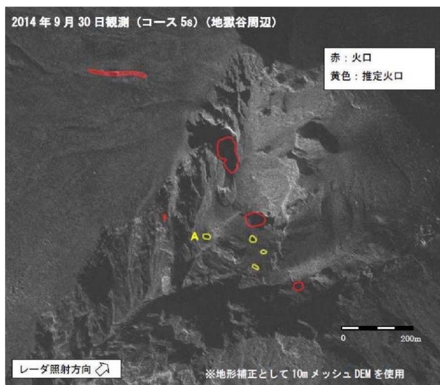
図 5-11 御嶽山噴火後の航空機搭載型合成開口レーダ（SAR）の観測画像解析結果から噴火口を推定した事例（リモートセンシング技術）
