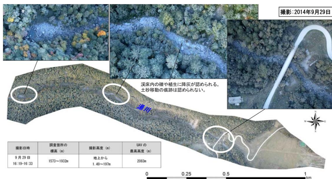
図 5-10 御嶽山噴火直後に実施したドローンによる降灰状況調査例
