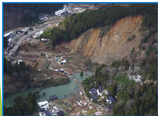
河原田川の斜面崩壊（R6.1.1能登半島地震）
