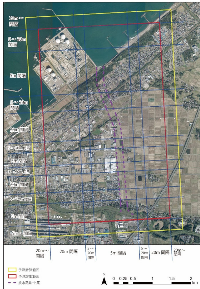
予測計算範囲: 水平方向3.0km(東西)×4.5km(南北)×鉛直方向250m
