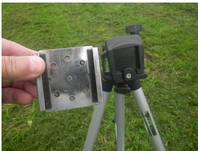
スタッフ取付部の改良
