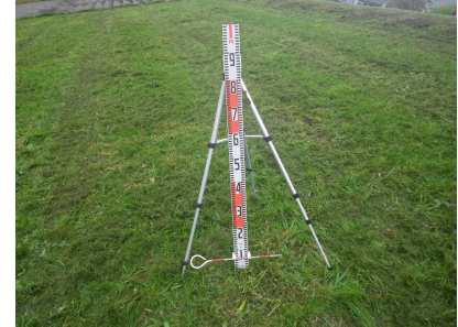
スタッフ取付状況
