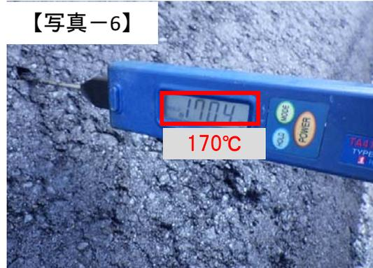
※⑥密粒度アスコン(新20FH)改質Ⅱ型 160℃以上 ①安定処理・②粗粒度アスコン(20) 140℃以上
