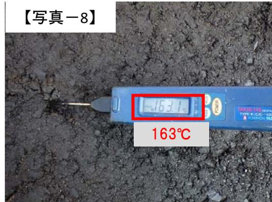
※⑥密粒度アスコン(新20FH)改質Ⅱ型 145℃以上 ①安定処理・②粗粒度アスコン(20) 130℃以上
