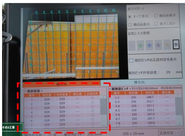
鉄筋計測システムの計測画面[写真-2]
