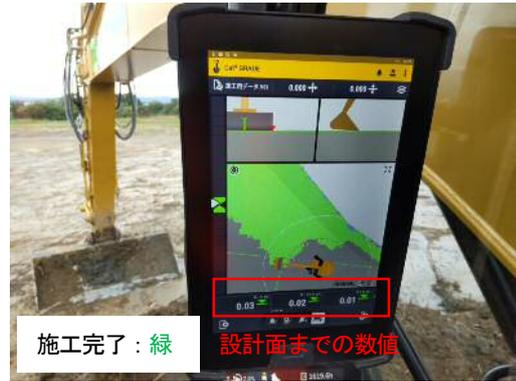
掘削状況及びマシンコントロール状況(バックホウモニター) [写真-1]
