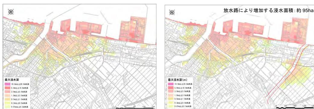
図 3-15 L2津波の最大浸水深図 (左：H29新潟県公表津波浸水想定、右：保倉川放水路整備後の国によるシミュレーション結果<sup>8)</sup>)
