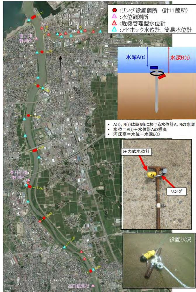
図 5-17 水位計付リング法による河床変動観測位置
