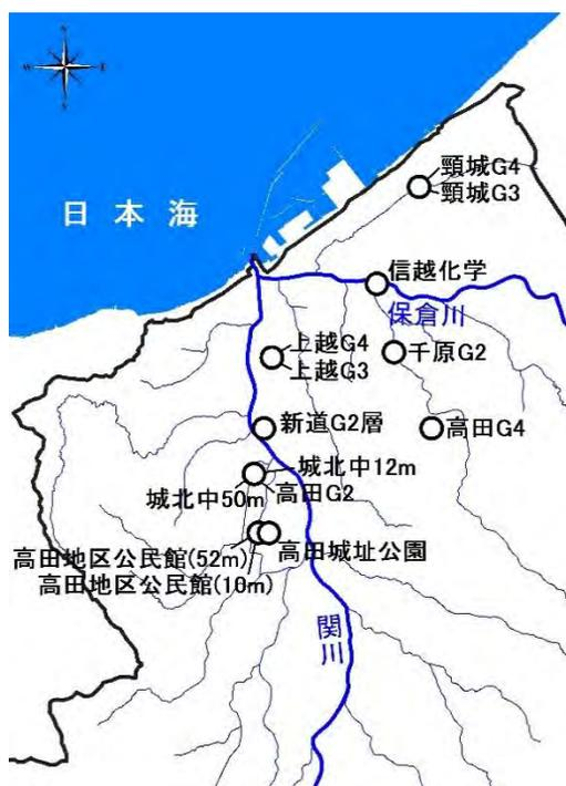
図 3-21 上越地区地盤沈下観測井位置図
