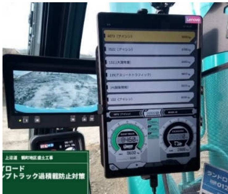
写真-4 バックホウ内のモニター
