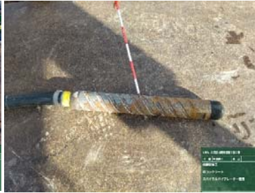
写-7 アクリル型枠による層厚・打設状況確認
