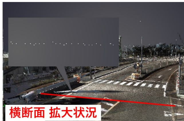
図 2 TLS で取得した点群
