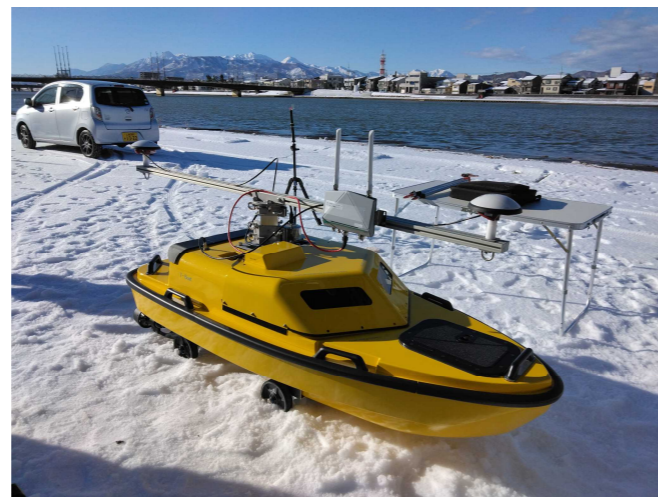
河床（川底）を測量するラジコンボート
