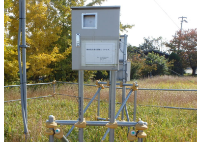
飛来塩分捕集器(土研式タンク法)設置状況
