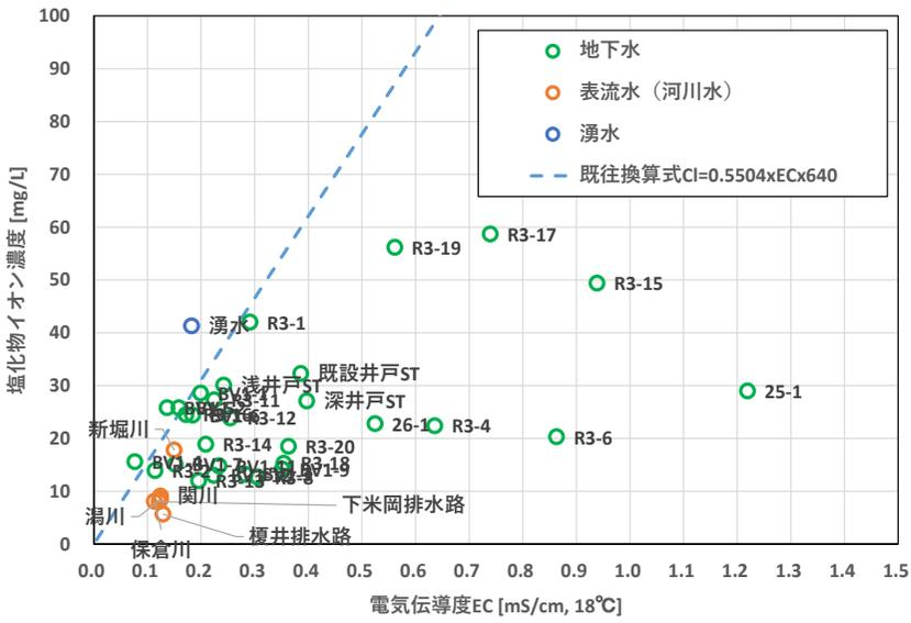
図 電気伝導率と塩化物イオンの相関図 (R5.6)
