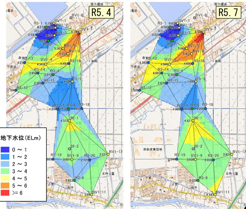
図 地下水位の平面分布の季節変化
