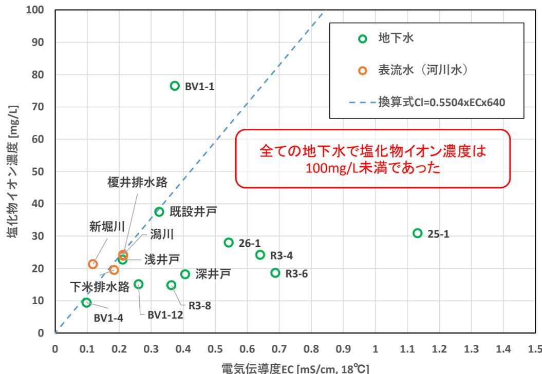
図 電気伝導率と塩化物イオンの相関図 (R4. 11~12)
