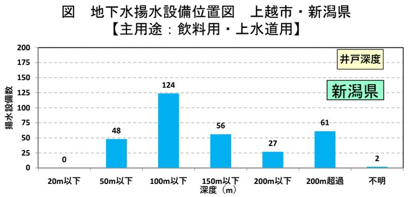
図 新潟県・上越市地下水揚水設備の井戸深度
