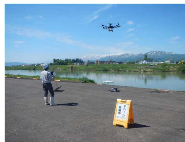
ドローンによる測量
