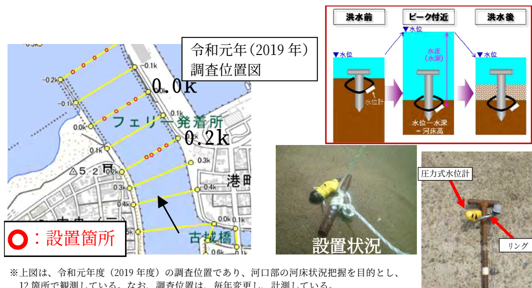
図3-5 洪水時河床モニタリング(リングセンサー設置)
