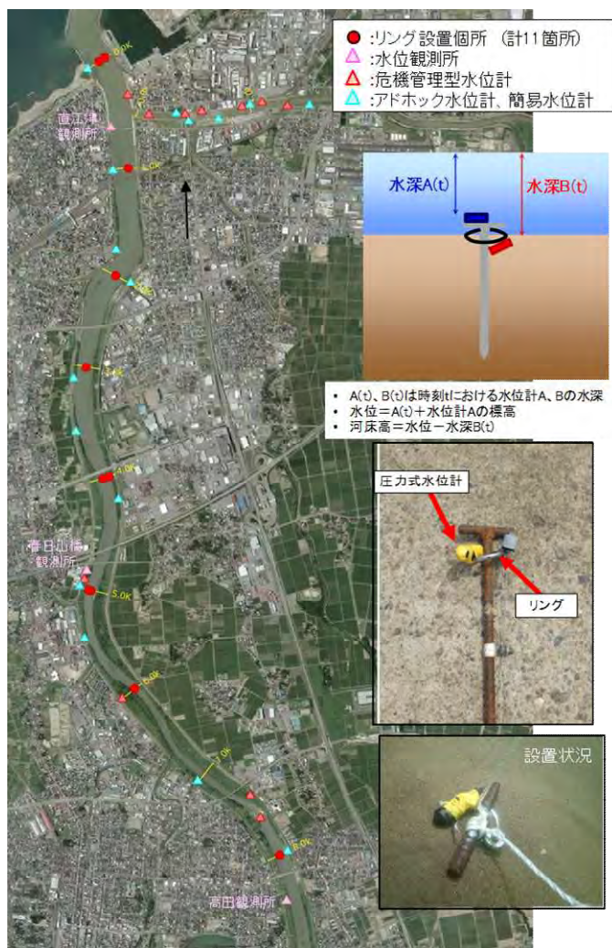
図 5-12 水位計付リング法による河床変動観測位置（令和 4 年度（2022 年度））
