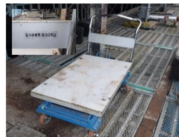
写真-5 油圧式リフト台車 (最大積載量800kg)
