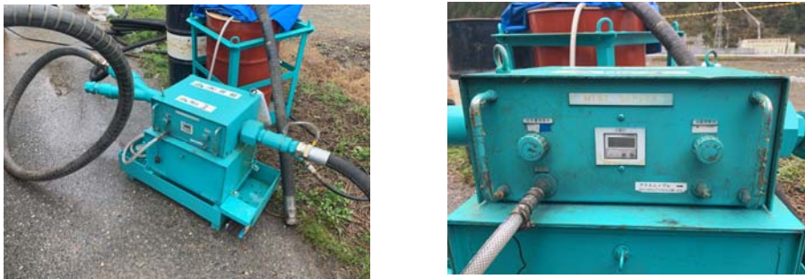
写真4 ラインオイラー(コンプレッサーに接続して使用)
