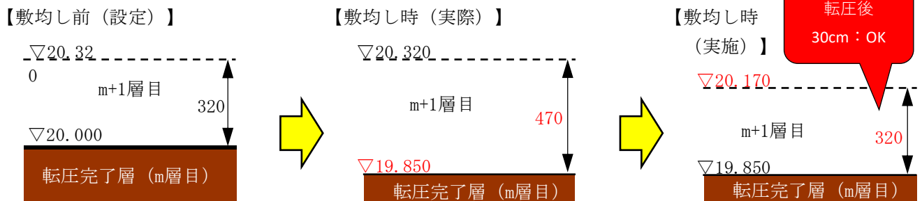
図-3-1. 敷均し転圧概要図
