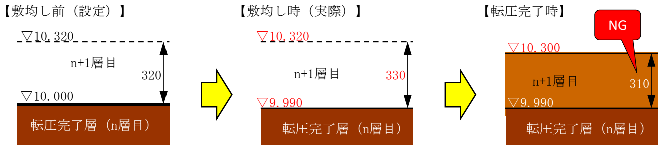
図-2-1. 敷均し転圧概要図
