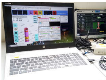
写真-5 施工管理システム(事務所側)
