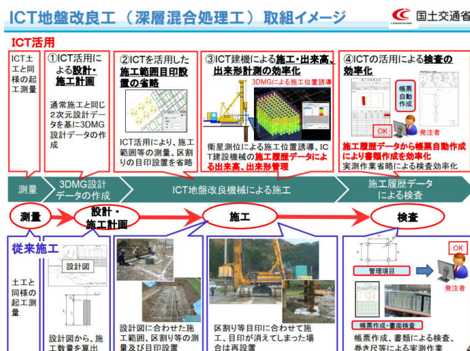
図-2 ICT 地盤改良工の取組イメージ
