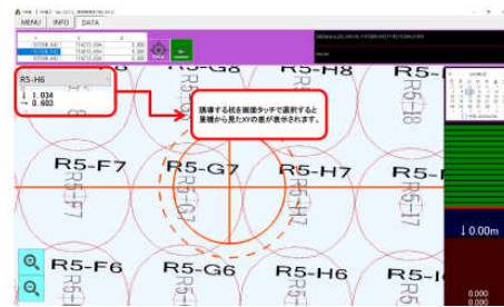
写真-4 GNSS 誘導画面
