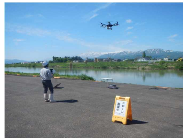
ドローンによる測量
