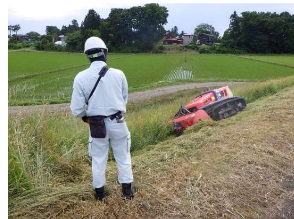
ラジコンによる除草作業の状況
