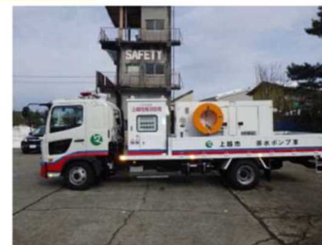
排水ポンプ車の配備
