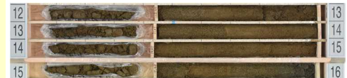
図2 Asg層(砂質土)のボーリングコア
