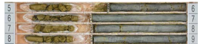
図2 Ac1-2層(粘性土)のボーリングコア
