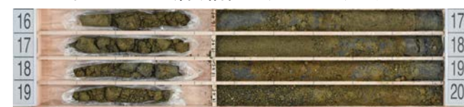
図2 As2層(砂質土)のボーリングコア
