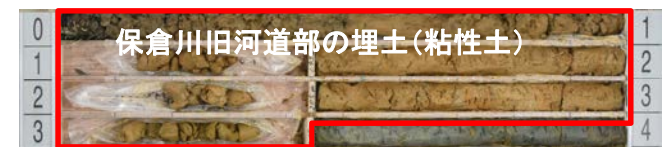
図1 Fi層(埋土)のボーリングコア
