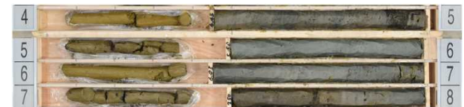
図1 Ac1-1層(粘性土)のボーリングコア
