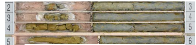
図1 Ac1-1層(粘性土)のボーリングコア
