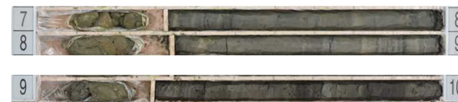
図1 Ac1-1層(上)とAp1層(下)のボーリングコア
