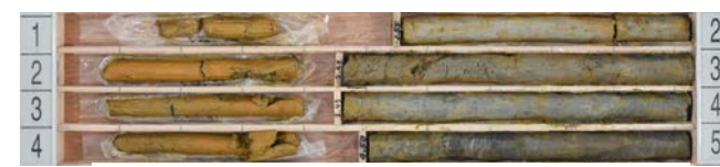
図1 Ac1-1層(粘性土)のボーリングコア
