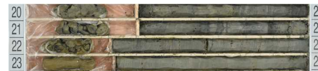
図2 Ac2-1層(粘性土)のボーリングコア
