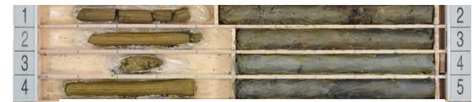
図1 Ac1-1層(粘性土)のボーリングコア
