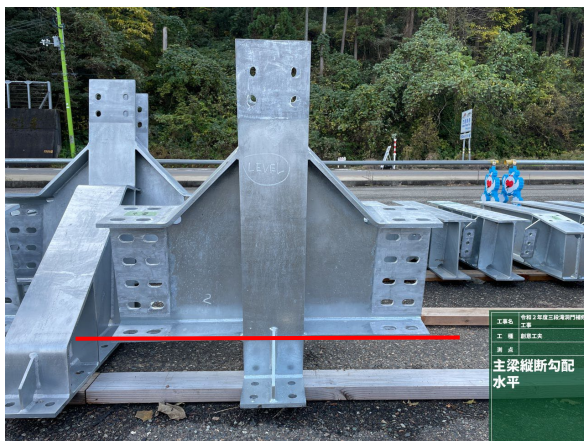
写真-3 主梁の水平と2.5%勾配部材
