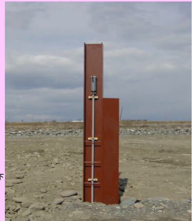
砂面計設置状況
