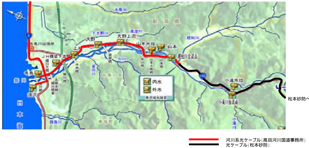
姫川水系CCTV・光ファイバーケーブル配置図
