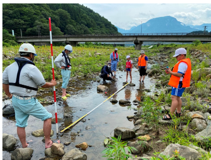
流速測定の様子 ピンポン玉が5mの距離を流れる時間を計測し、流速を調べました。
