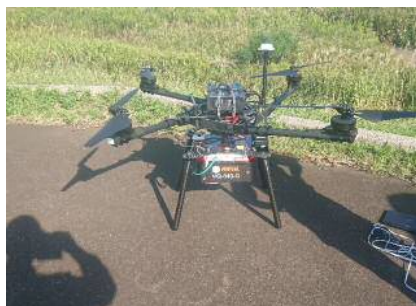
UAV搭載型グリーンレーザースキャナ(写真-1)
