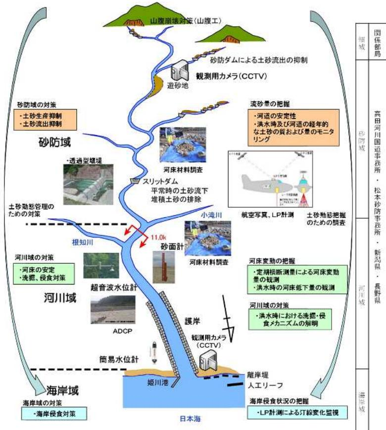
図-7.9 姫川における流域の総合的な土砂管理（土砂動態モニタリング）
