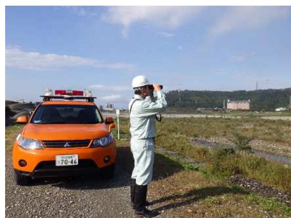
図-5.4 平常時の河川巡視（護岸の目地の開き調査と対岸からの変状目視）
