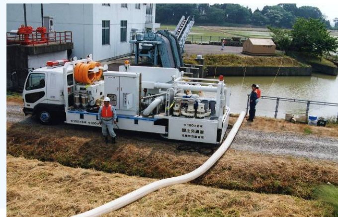
排水ポンプ車による排水訓練
