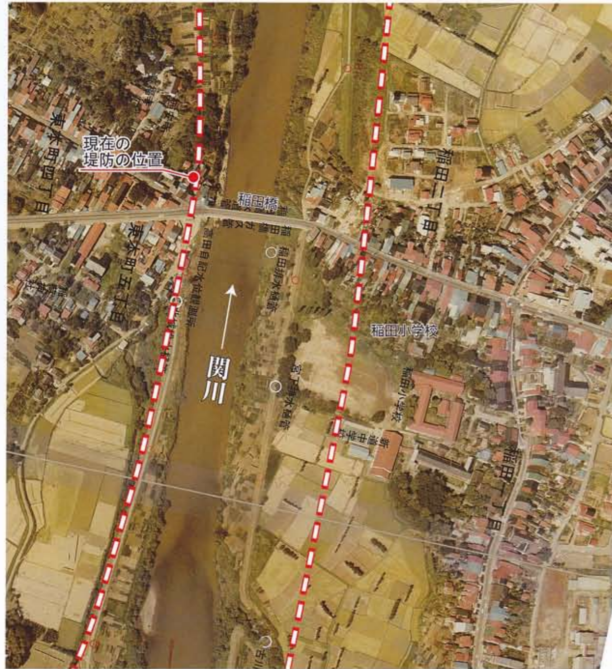
激特事業（河川激甚災害対策特別緊急事業）により、稲田橋付近は約100m程度だった川幅が約200mに広がりました。
