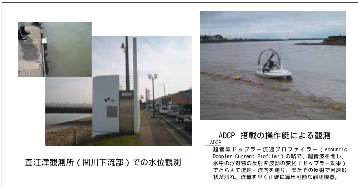
図 5-26 洪水ピーク時に推定される河床形状の調査
