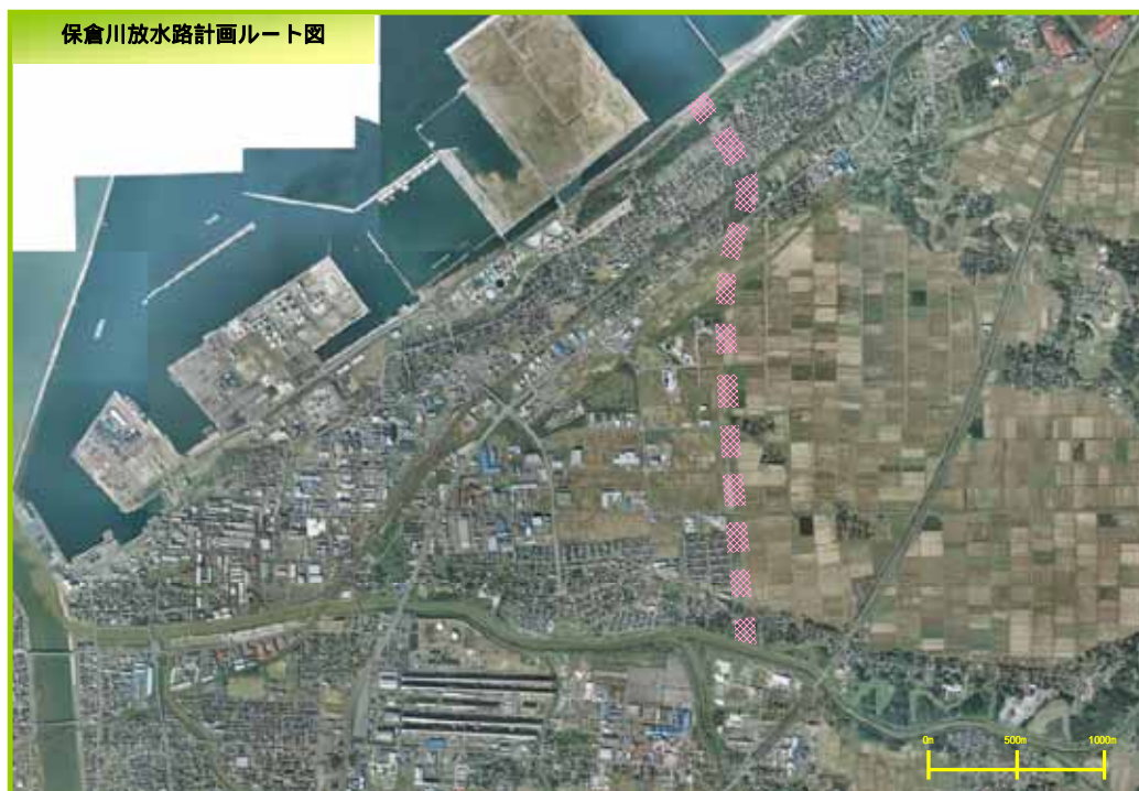
図 5-3 保倉川放水路概略ルート(案)と航空写真
