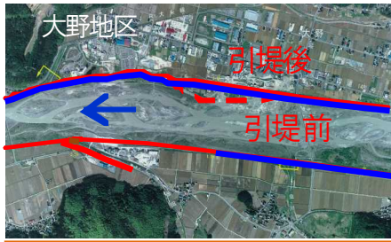
引堤工事 (H2~H13) 狭窄部における引堤と築堤を実施
