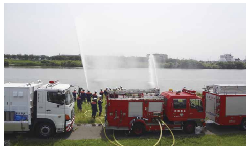
排水ポンプ車から消防車に給水
