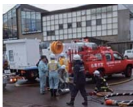
排水ポンプ車による 送水支援
