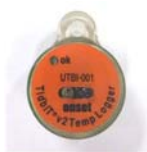
左:自記式水温計 右:ブロックに固定し投入 百合居橋の水温計 西大滝ダム魚道の水温計
