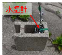
左:自記式水温計 右:ブロックに固定し投入 百合居橋の水温計 西大滝ダム魚道の水温計
