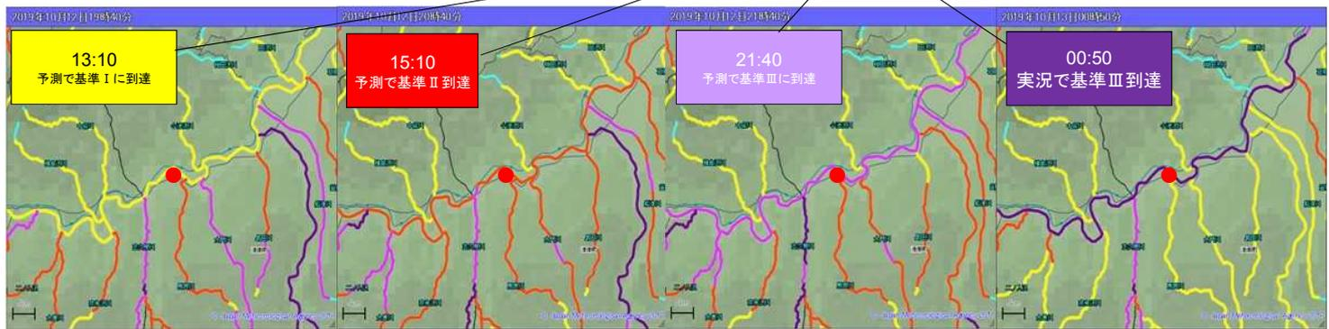
危険度分布部外向け(予測あり)では、発災格子で13:10に予測で基準Ⅰ(注意報)に達し、15:10に予測で基準Ⅱに到達。21:40には予測で基準Ⅲに到達、00:50に実況で基準Ⅲに到達した。08:18には十日町振興局より足滝での氾濫発生情報レベル5が発せられた。被災格子の指数は越水当時すでに基準Ⅲを実況超過しており、いつ発災してもおかしくない状況あり、流域雨量指数、危険度分布の対応は良好であった。水位周知区間の割野では当時避難判断水位を超過していないため、割野上流の洪水の危険度を確認する手段として危険度分布は有効であった事例。9直轄区間は洪水予報を、水位周知区間は水位到達情報を、それ以外の河川区間は危険度分布の活用する事が望ましい。
