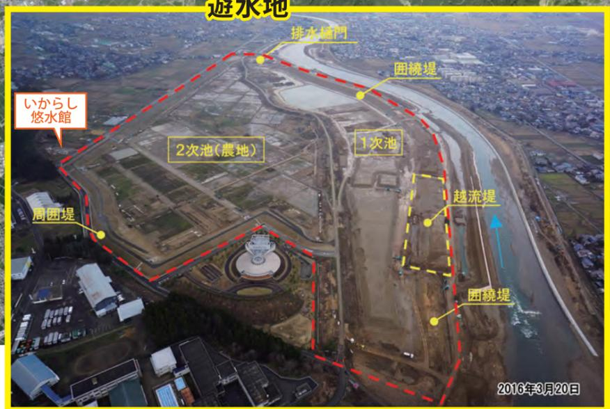
周囲堤の築造が完了し、囲繞堤、越流堤、排水樋門の本体工事を本格的に実施しています。
