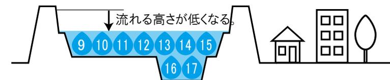
遊水地に洪水流量の一部を一時的に貯めることで、下流を流れる水位の高さが低くなる。
