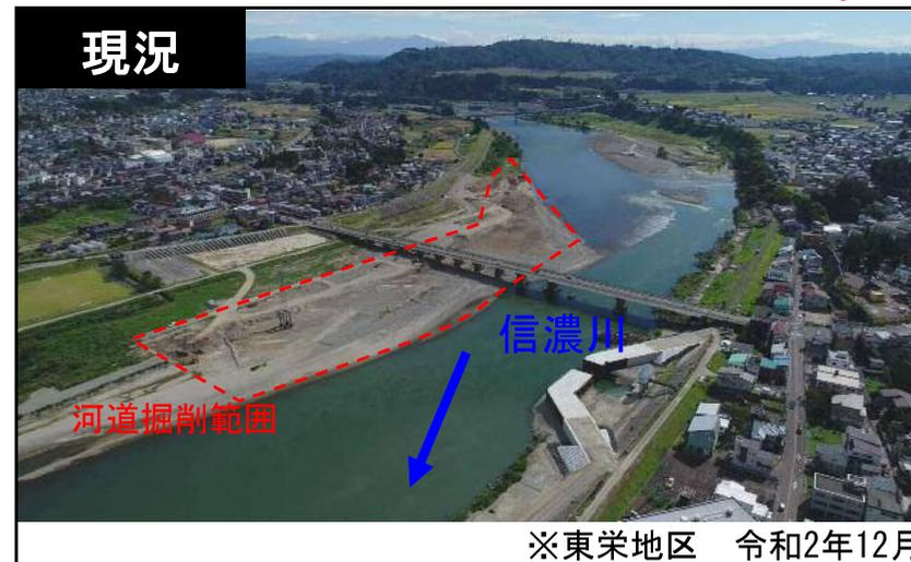
○当該区間の護岸は、河岸侵食により平成29年度に根固工を設置し、堤防機能確保を図ってきましたが、令和元年東日本台風では、上流側の砂州の拡大に伴い、護岸が水衝部となりました。
