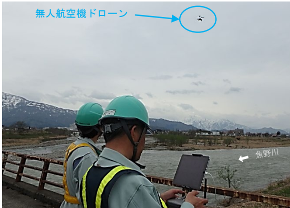
無人航空機ドローンによる河道調査状況（魚沼市岡新田地先）
