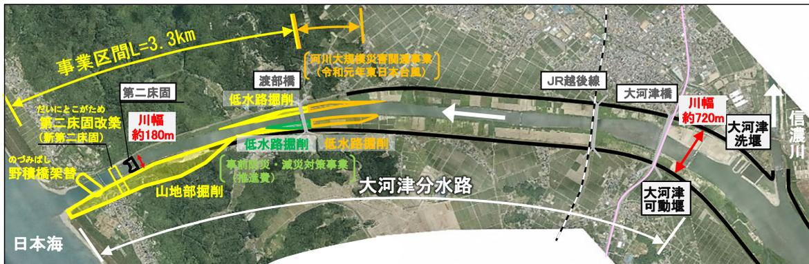
令和3年度は、山地部及び低水路掘削、第二床固改築、野積橋架替等を引き続き推進します。なお、山地部の掘削土は、「大河津分水が“ひらく”地域活性化プロジェクト」として、堤防の強化に活用している他、地域の活性化につながる周辺自治体の事業への有効活用を行っています。また、大河津分水路「令和の大改修」では、効率的・効果的な施工を進めるため、BIM/CIM（Building and Construction Information Modeling/Management）の導入を行っています。
