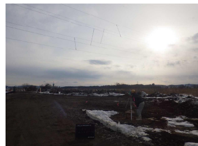
「送電線地上高測定」
