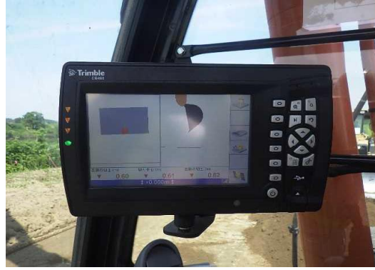
MGバックホウによる整地状況
