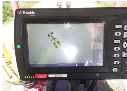
MCグレーダーによる下層路盤整正状況
