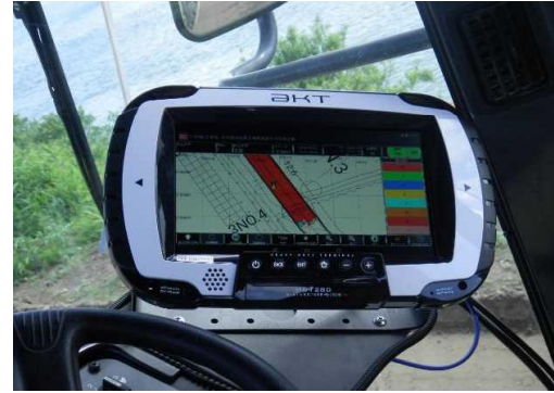
GNSSを用いた転圧管理状況
