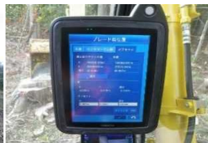
刃先確認（バケット位置精度確認）
