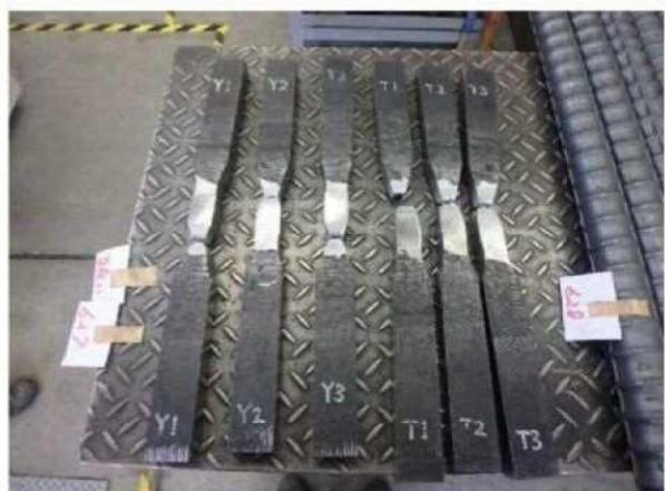
写-2 母材破断状況
