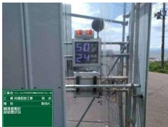
図・9 騒音・振動測定器による測定状況
