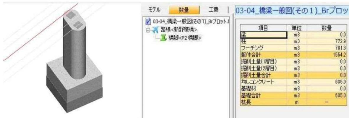
図-7 3DCADによる数量算出
