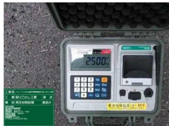
図・17 積載量確認状況
