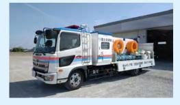
台風や集中豪雨により宅地や道路が冠水した際、被害を最小限に抑えるためにあふれた水をくみ上げて川に排水する車両です。
