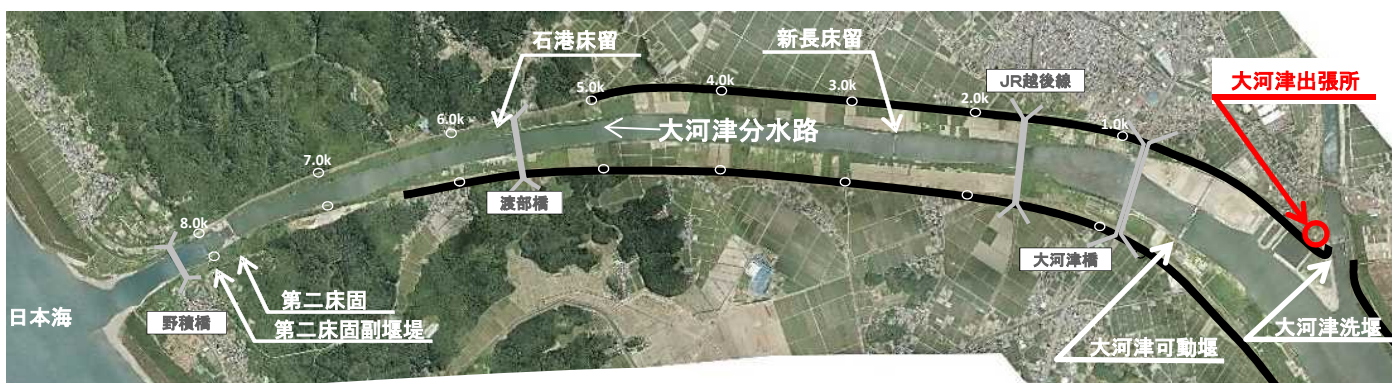
流下能力が不足し抜本的な改修が必要な大河津分水路 ～「令和の大改修」実施中～
