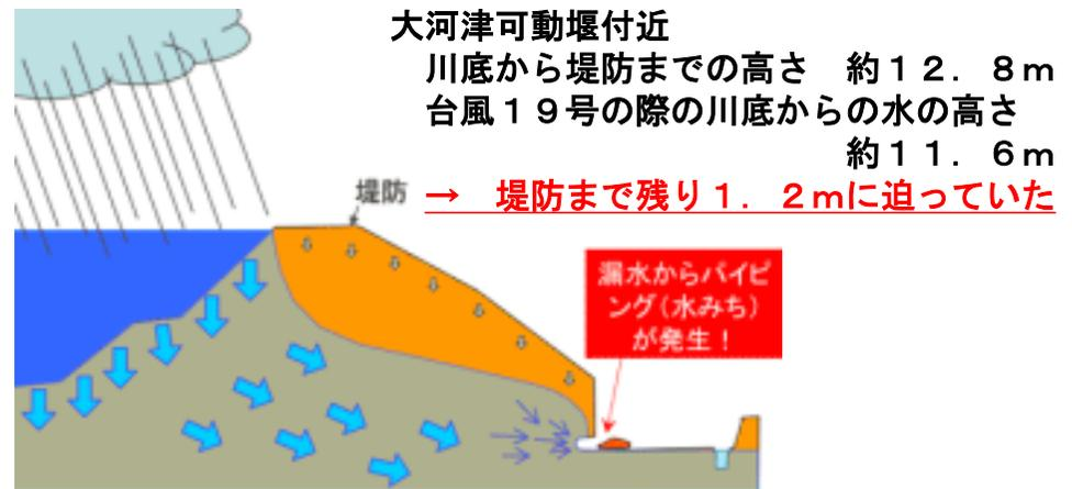
高水位=高水圧 堤防に洪水が浸透 漏水等を起こす 3
