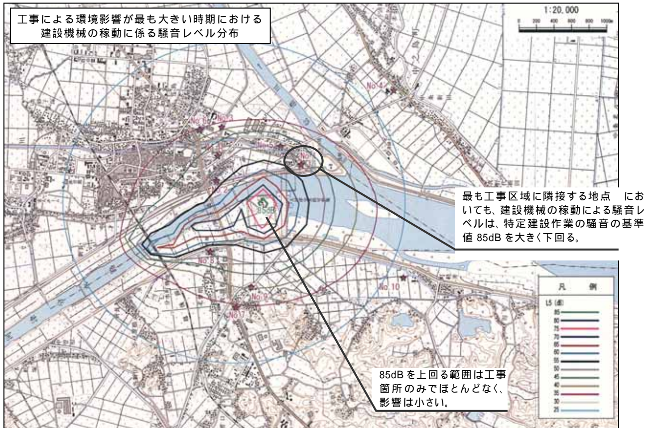
図 3.6 建設機械の稼働に係る騒音レベルの分布図（コンター図：L5）
