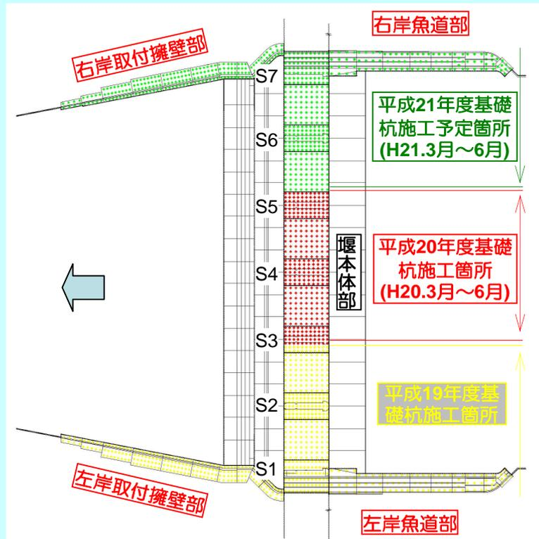
平成19年3月より左岸側（下流に向いて左側）から堰本体を支えるための基礎となる杭（鋼管杭）を施工しています。杭の直径（太さ）は、0.8m～1.1m、杭の長さは、2.5m～11.0mのものを平成20年6月までに983本の杭を施工しています。平成21年3月以降も右岸側に向けて順次施工中であり、平成21年6月までに約300本の杭を施工する予定です。
