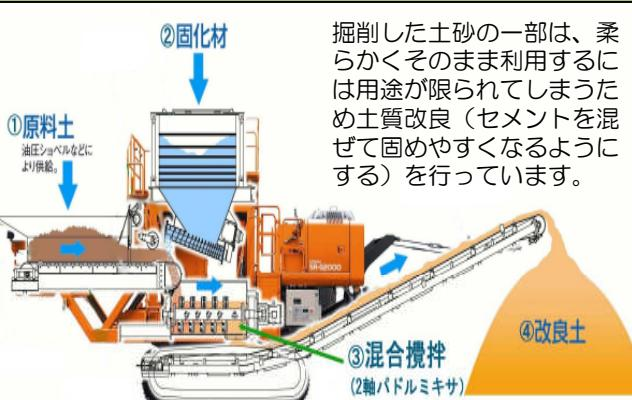
掘削した土砂の一部は、柔らかくそのまま利用するには用途が限られてしまうため土質改良（セメントを混ぜて固めやすくなるようにする）を行っています。
