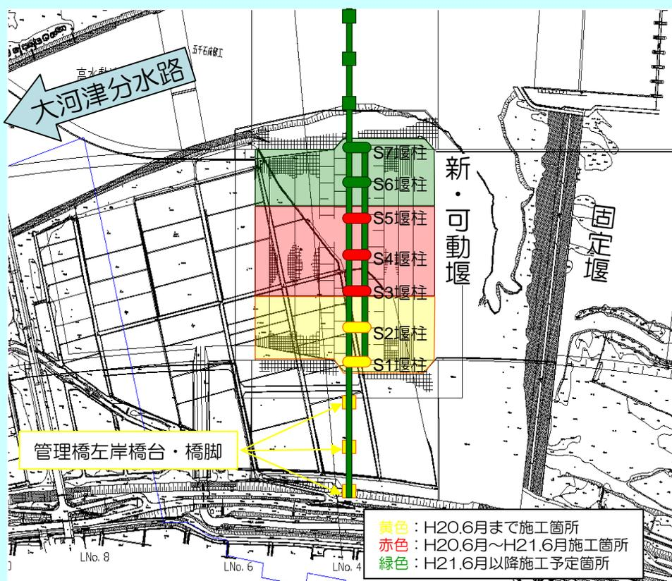
平成21年6月までに堰中央部の堰柱3基（S3堰柱、S4堰柱、S5堰柱）、水叩き、護床工を完成させる予定です。
